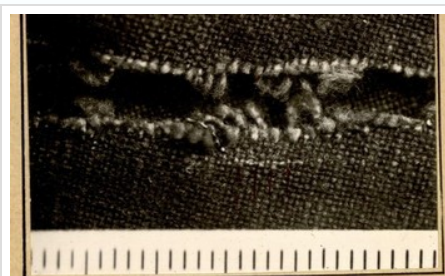
Photo N.10 Partial incision of filaments near the edge of
